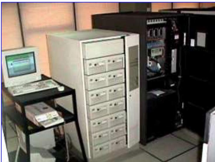
**El IBM ES/390 9121 - 621 que operó en la DPIN desde fines de 1.995 hasta el 31 de octubre de 1.999. La consola de control, el arreglo de discos y las entrañas de la mainframe**
