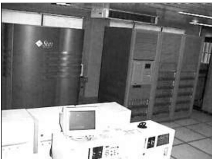
**El Sun E10000 de la DPIN con el “robot” de cintas magnéticas y el rack de discos rígidos. En la parte inferior, equipamiento antiguo de IBM**
